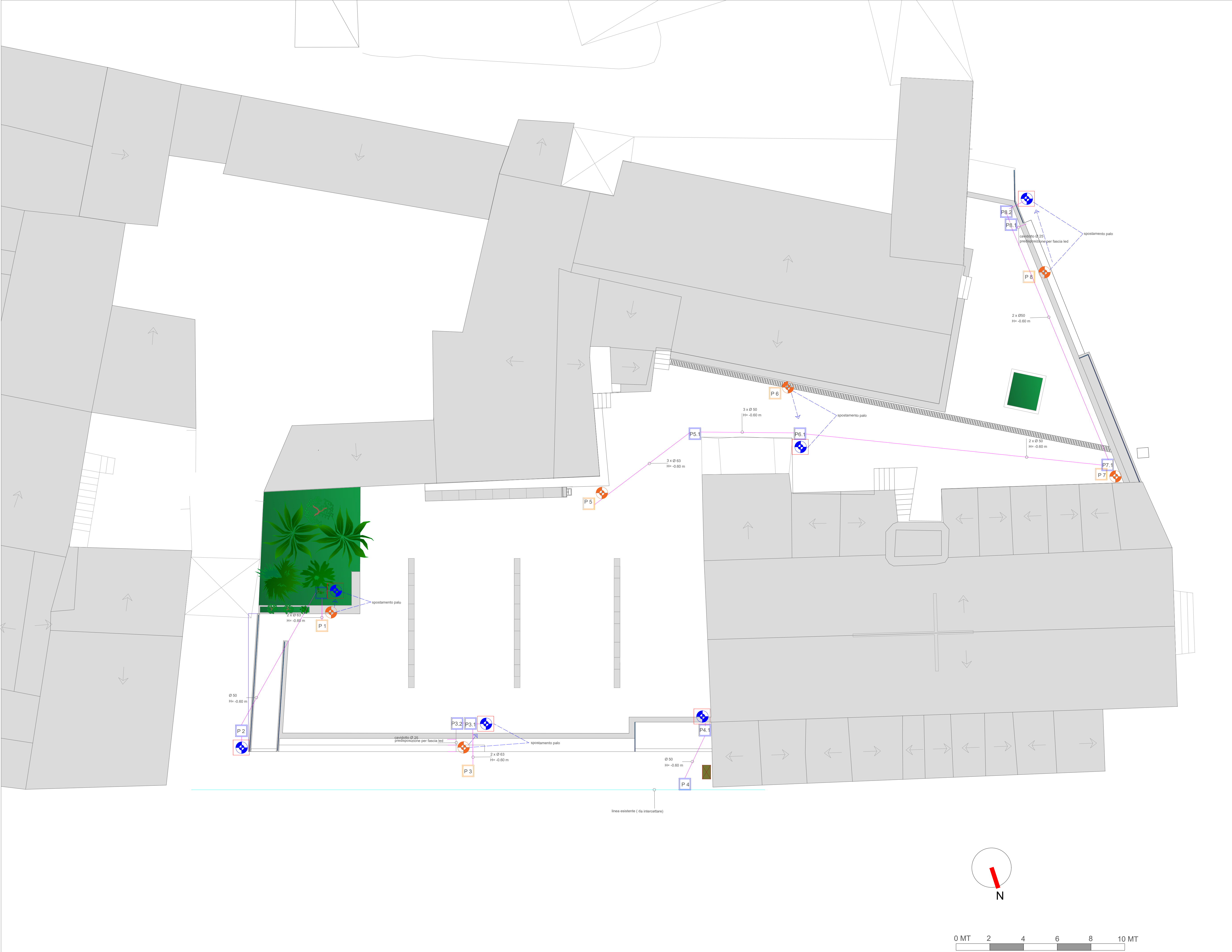
DISTRIBUZIONE CAVIDOTTI E POSIZIONAMENTO PALI - scala 1:100
